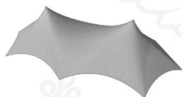
Exemplo: Elemento tensionado
